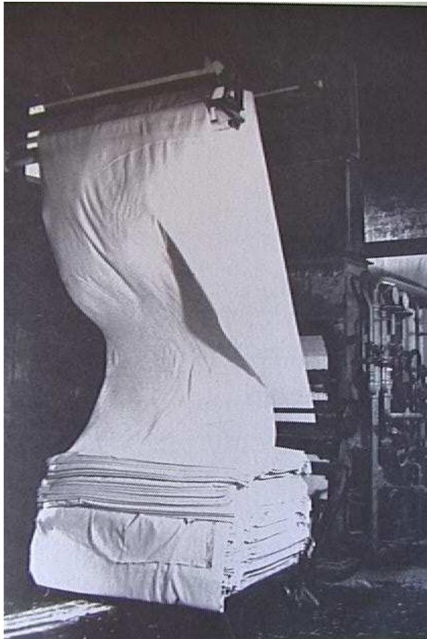
*Plieuse de velours (anc. Usines Cosserat Amiens) Le velours aux apprêts à la sortie d'une rame de séchage : entre deux plis, recul, avancée , repli....*
